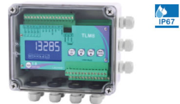
IP 67 Ausführung in ASB Box Mit 8x3 PG Verschraubungen 185x185x130 mm.
